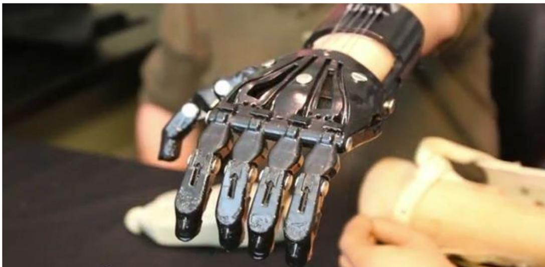
*Рисунок 5 – Механизированный протез руки*
