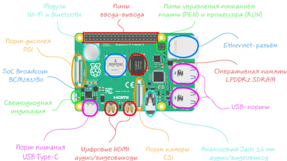
Рисунок 5 – Элементы Raspberry Pi 4
