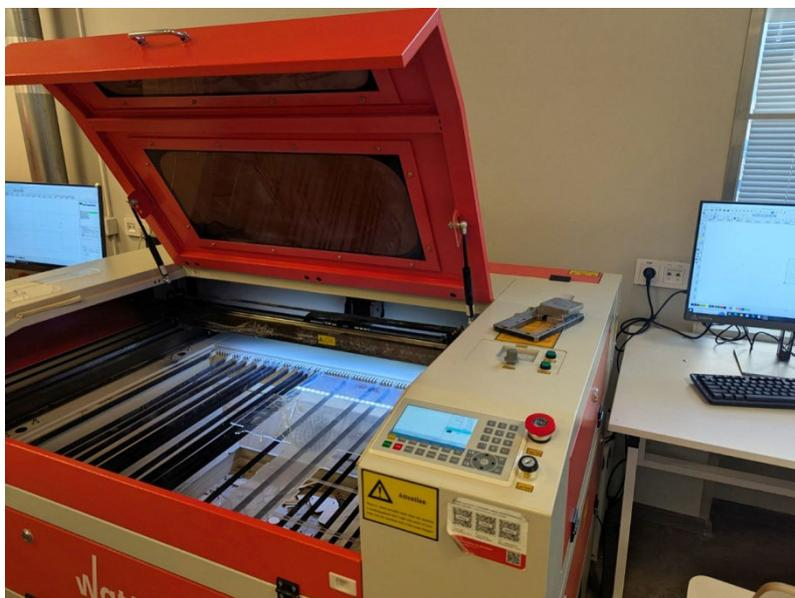
*Рис. 21 Изготовление элементов на станке лазерной резки*
