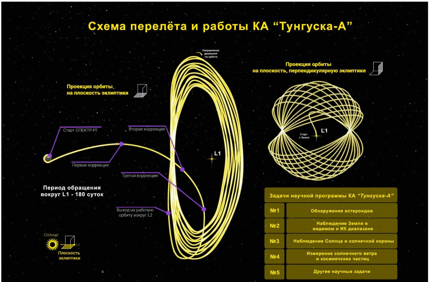
Рисунок 6.2 – Схема перелета космического аппарата с орбиты Земли в точку Лагранжа L1
