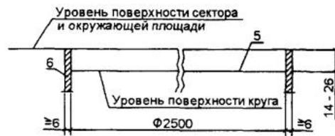
Рисунок 2 – Чертеж сектора для метания диска
