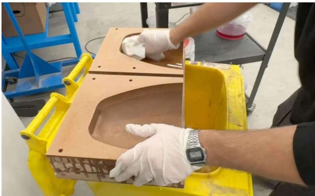
*Рисунок 16 – Очистка рабочих поверхностей оснастки*
