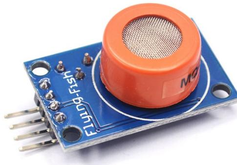
Рисунок 11 – Датчик MQ-3
