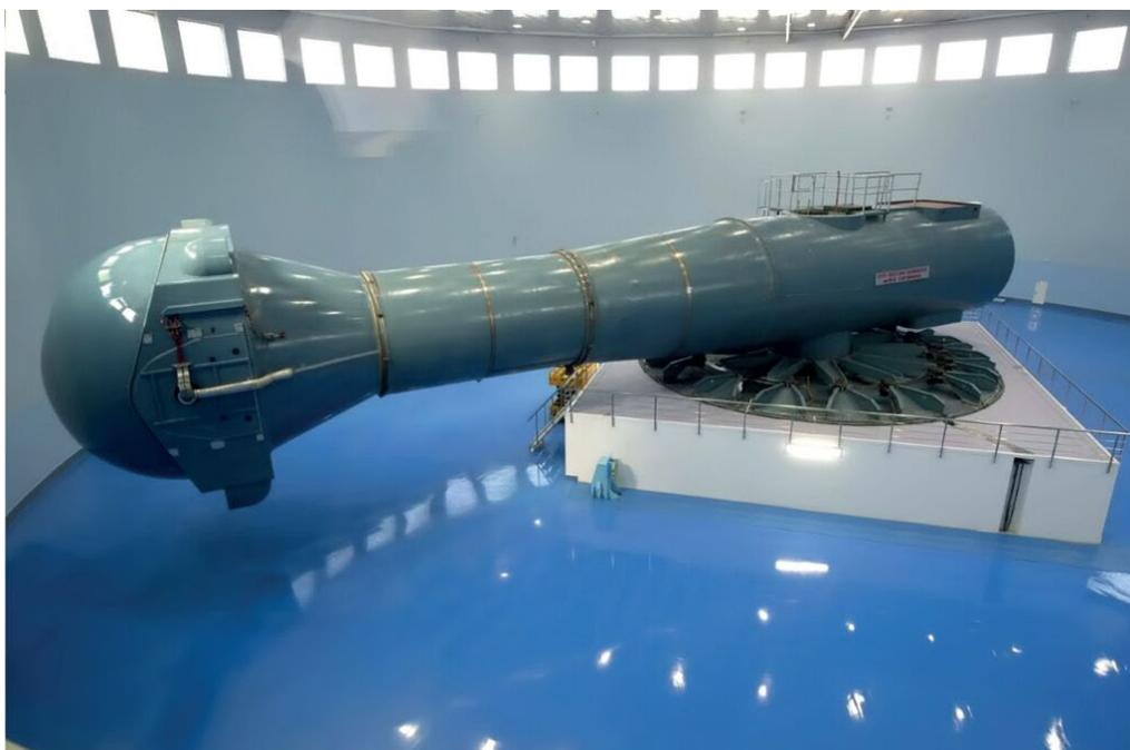
*Рисунок 1.1 Центрифуга с плечом 18 м (ЦФ-18) в Центре подготовки космонавтов.*
