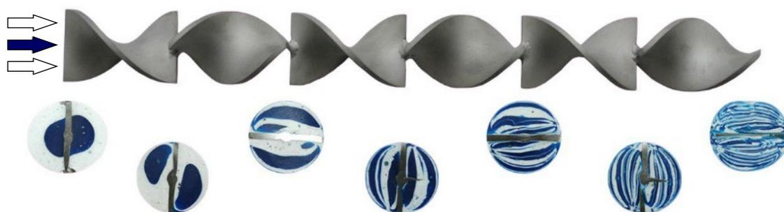
Рисунок 20 – Степень смешивания в зависимости от числа элементов
