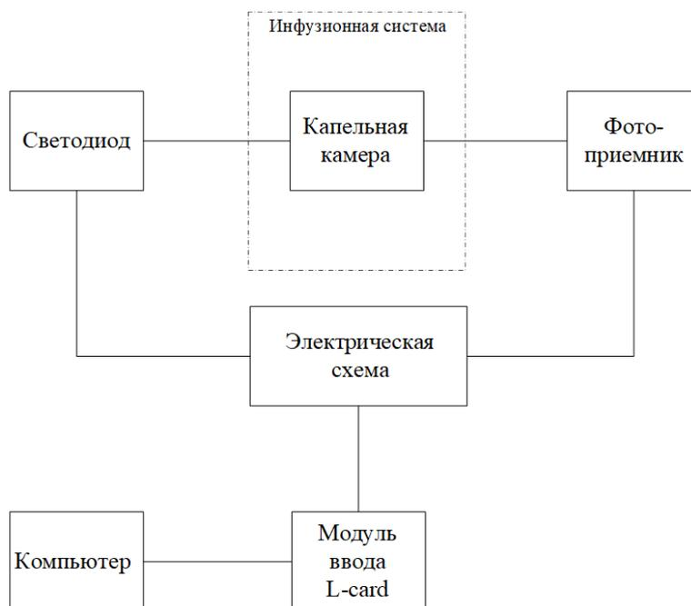
Рисунок 8 – Схема экспериментального стенда
