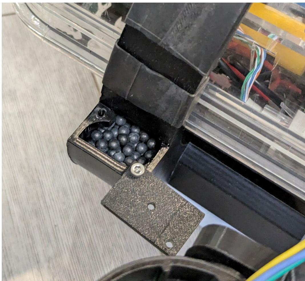
*Рис. 18 Дробь, используемая в качестве балласта*
