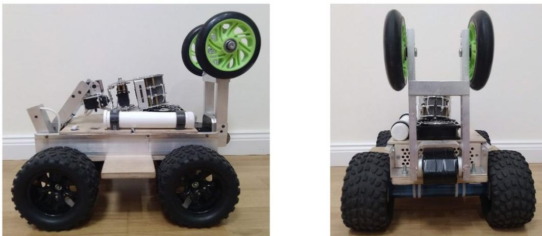
Рисунок 4 – Робот после установки дополнительных колёс
