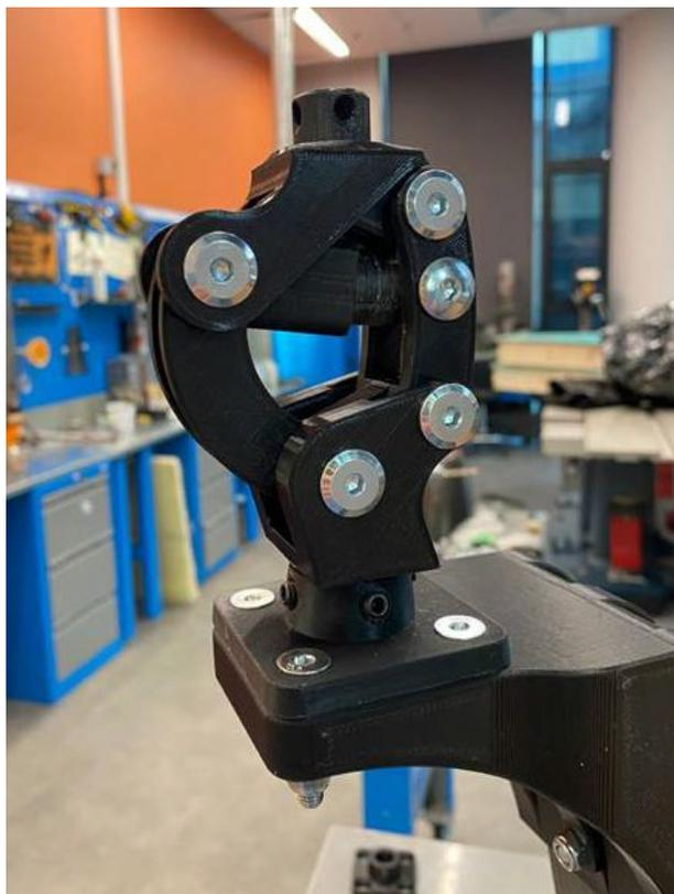
*Рисунок 28 – Коленный сустав протеза в сборе*
