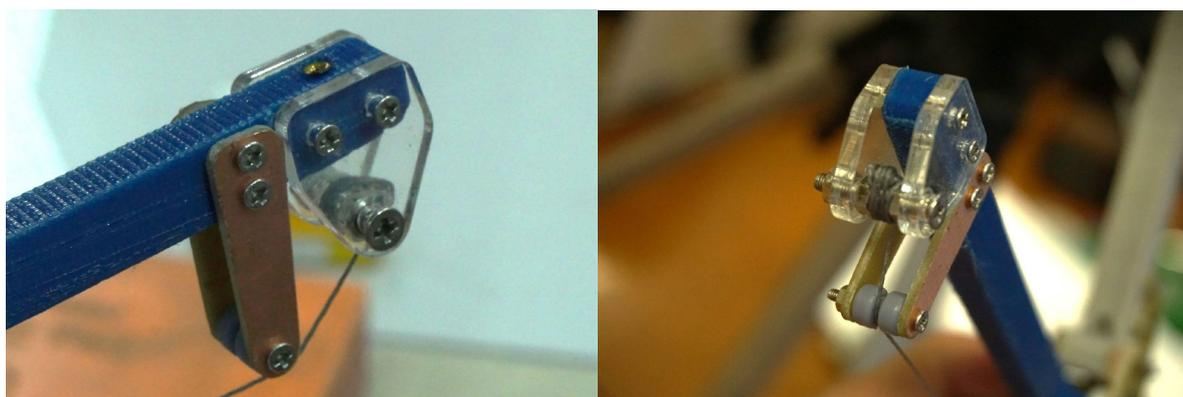
Рисунок 28 - Конструкция узла преднатяжения на прототипе
