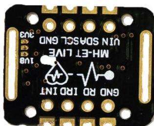
Рисунок 9 – Датчик пульса и уровня SpO<sub>2</sub>
