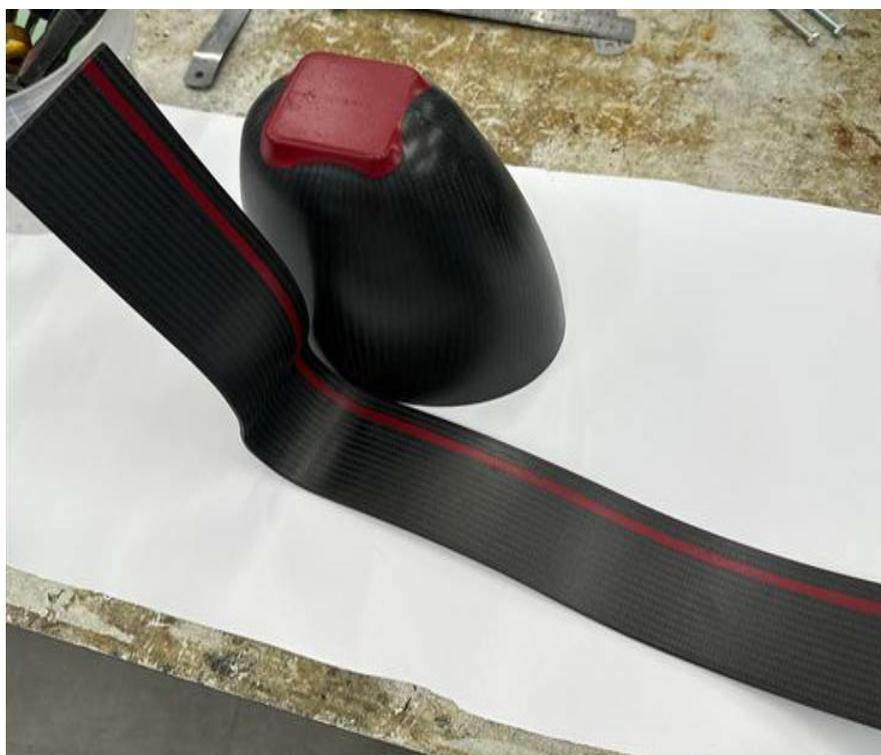
*Рисунок 27 – Композитные части протеза с рисунком, покрытые лаком*
