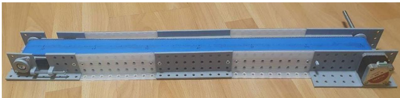
Рисунок 12 – Конвейер в сборе с дополнительной резиновой лентой
