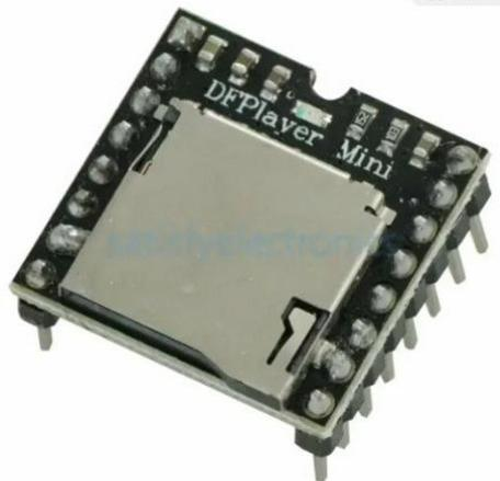
Рис. 6. Плата mp3-модуля
