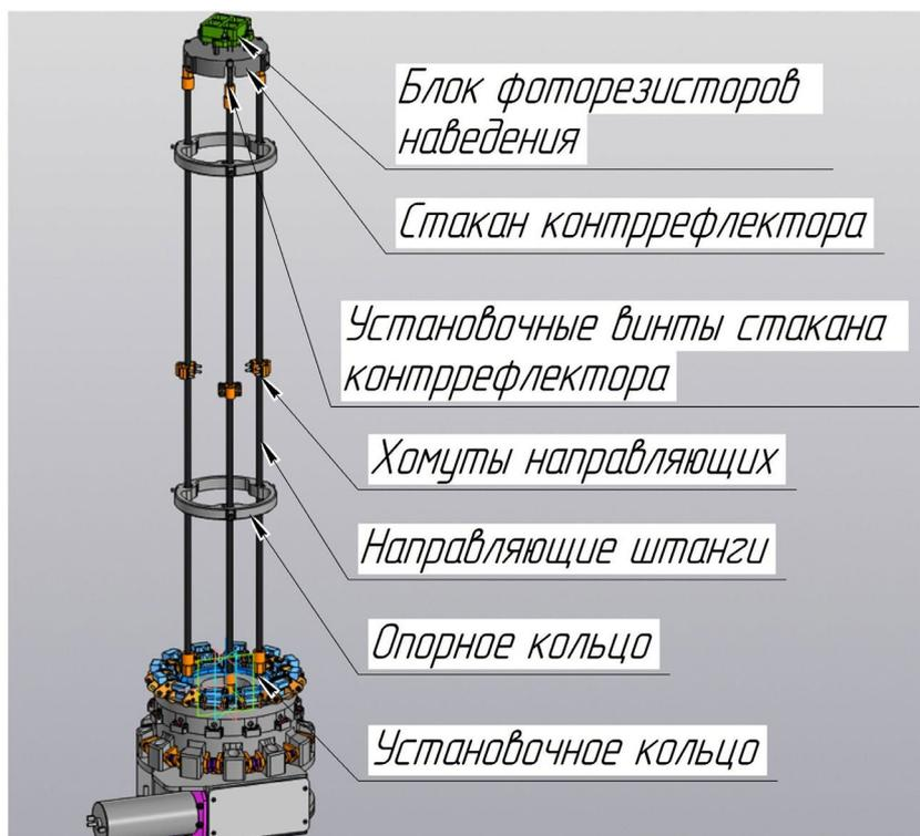
Рисунок 21 - Состав штанги контррефлектора
