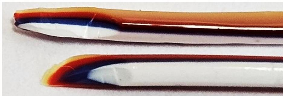
Рисунок 18 – Срез результирующей нити без смешивания
