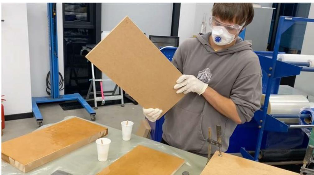
*Рисунок 12 – Склеивание заготовки из МДФ*
