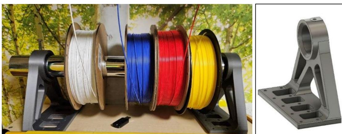
Рисунок 7 –Держатель катушек с пластиком
