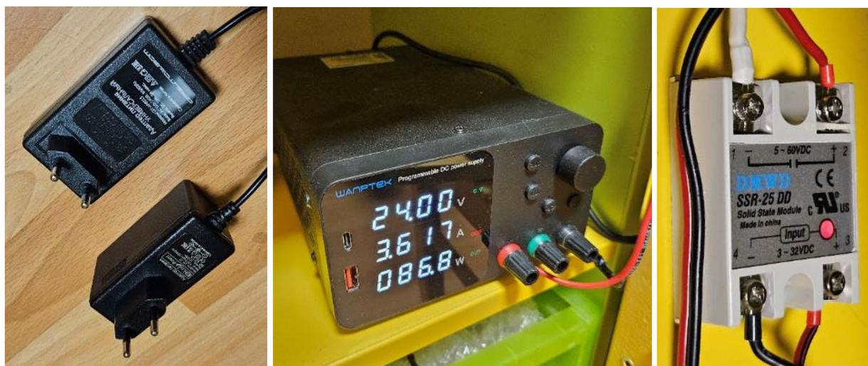
Рисунок 14 – Блоки питания и твердотельное реле
