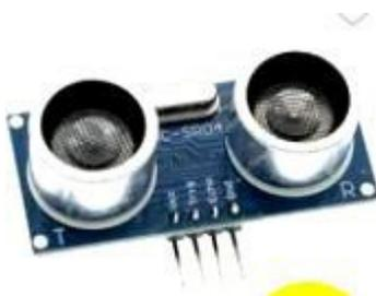
*Рис. 4. Датчик расстояния*
