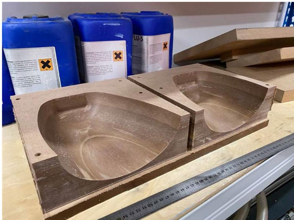
*Рисунок 15 – Оснастки культеприемной гильзы после чистовой фрезеровки*
