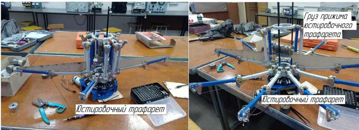
Рисунок 29 - Юстировочный трафарет в процессе юстировки
