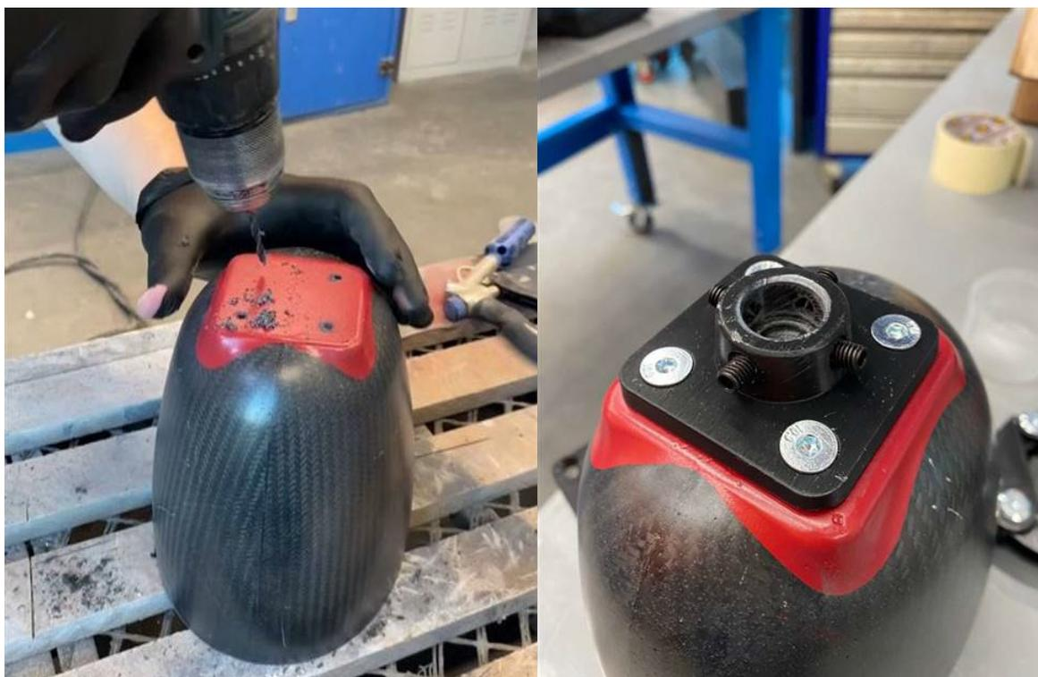
*Рисунок 30, 31 – Сверление отверстий и сборка культеприемной гильзы*
