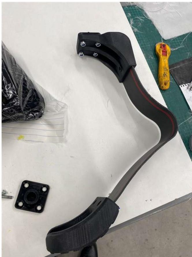
*Рисунок 29 – Голень с кронштейном и накладкой стопы, напечатанными на 3D-принтере*
