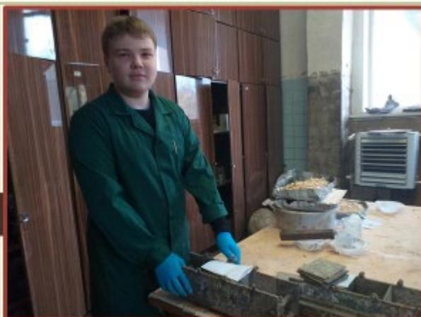
**Замыкание пресс-формы с уплотненной арболитовой смесью**
