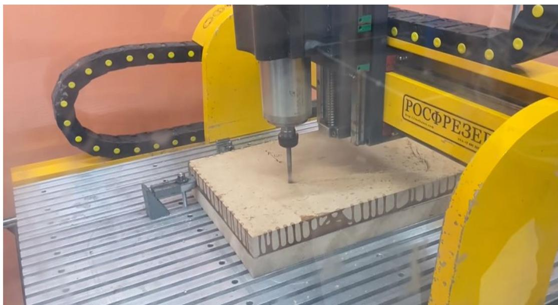
*Рисунок 13 – Фрезеровка оснасток на станке с ЧПУ*
