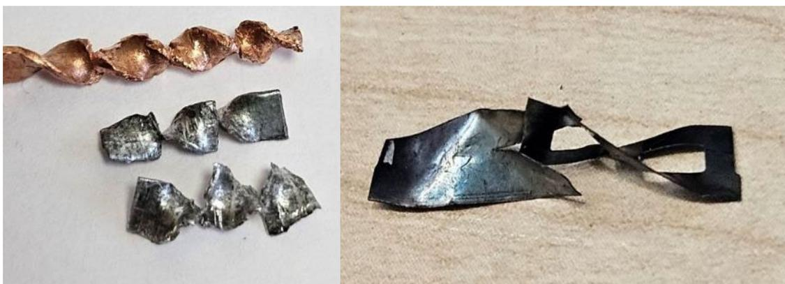
Рисунок 21 – Смешивающий элемент из разных материалов
