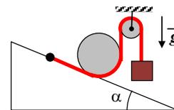
Чему равен угол наклона  $\alpha$  наклонной плоскости, при котором эта система находится в равновесии? Массой веревки пренебречь. Свисающие с блока отрезки веревки – вертикальны. Блок – гладкий.
