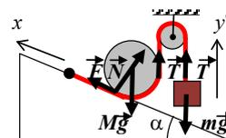
Т.к. бревно и груз неподвижны, то в проекциях на оси  $x$  и  $y'$ , получим уравнения:
