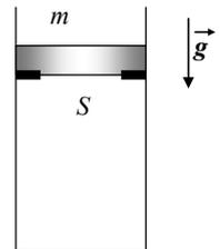
Считая известными значения относительного уменьшения объема газа  $\varepsilon_V = \frac{|\Delta V|}{V_1}$  и относительного увеличения его температуры  $\varepsilon_T = \frac{\Delta T}{T_1}$  после того, как поршень снова окажется в равновесии, найдите массу  $m$  поршня. Начальный объем газа  $V_1$  и его начальная температура  $T_1$  не известны. Трение между поршнем и стенками сосуда отсутствует.
