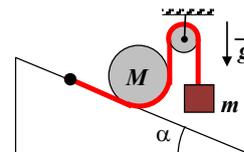
Чему равна масса  $m$  груза, при которой эта система находится в равновесии? Массой веревки пренебречь. Свисающие с блока отрезки веревки – вертикальны. Блок – гладкий.
