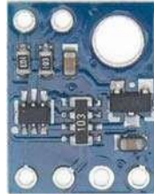
Рисунок 27 – Лазерный дальномер на основе VL53L0X
