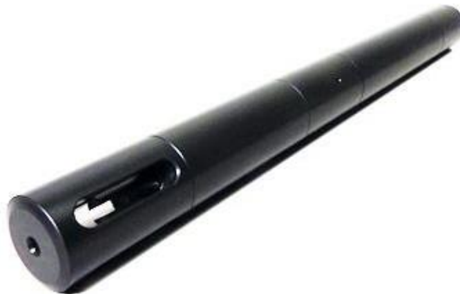
Рисунок 1 — Профилограф-CTD, зонд "Гидрометрика 505-УТП"
