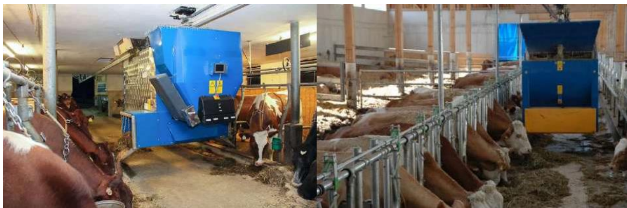
Рисунок 10 – Кормовагон движущийся по подвесной рельсе
