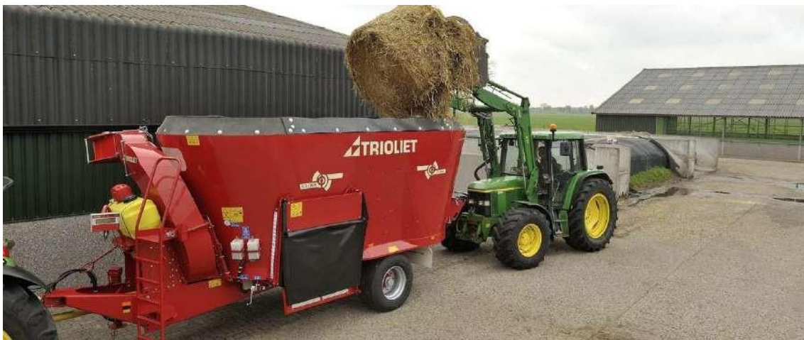
Рисунок 1 – Процесс загрузки прицепного смесителя-раздатчика кормов фронтальным погрузчиком
