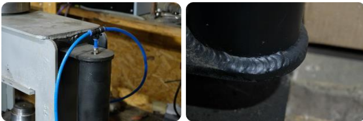
Рисунок 21 – Пневморесивер после сварки и испытания сварного шва.
