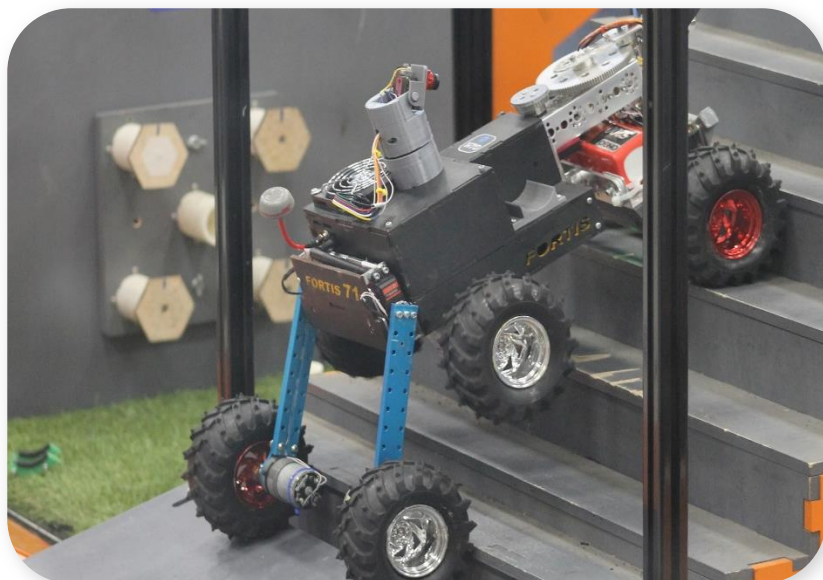
Рисунок 19 – Тестовый подъем робота по лестнице
