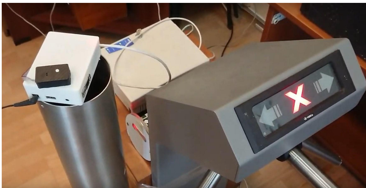
Рисунок 22 – Разработанное устройство, подключённое к турникету
