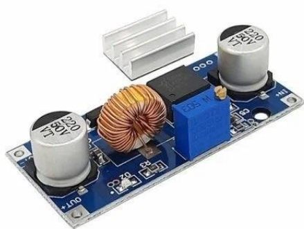
Рисунок 9 – Понижающий DC-DC преобразователь XL4015
