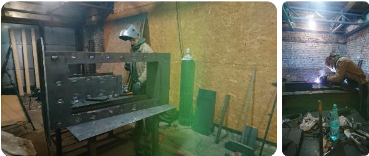
Рисунок 18 – Сварка и сборка корпуса пресса
