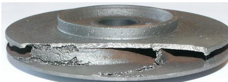
*Рис. 3 Повреждение, нанесенное кавитацией детали насоса.*
