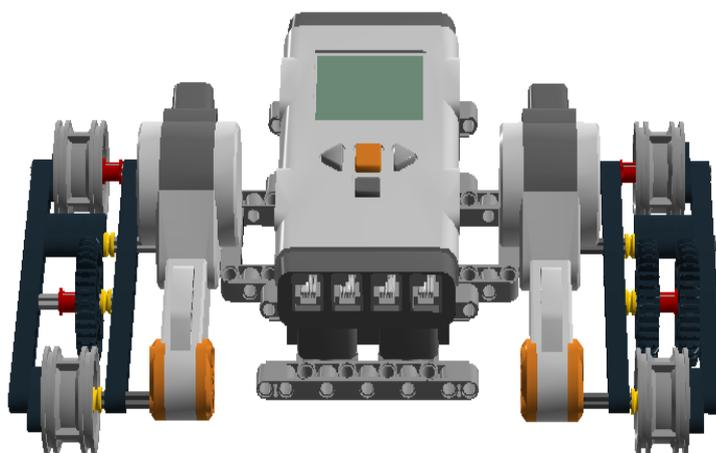
Рисунок 14 – Бортовой компьютер с несущей рамой и движущей системой
