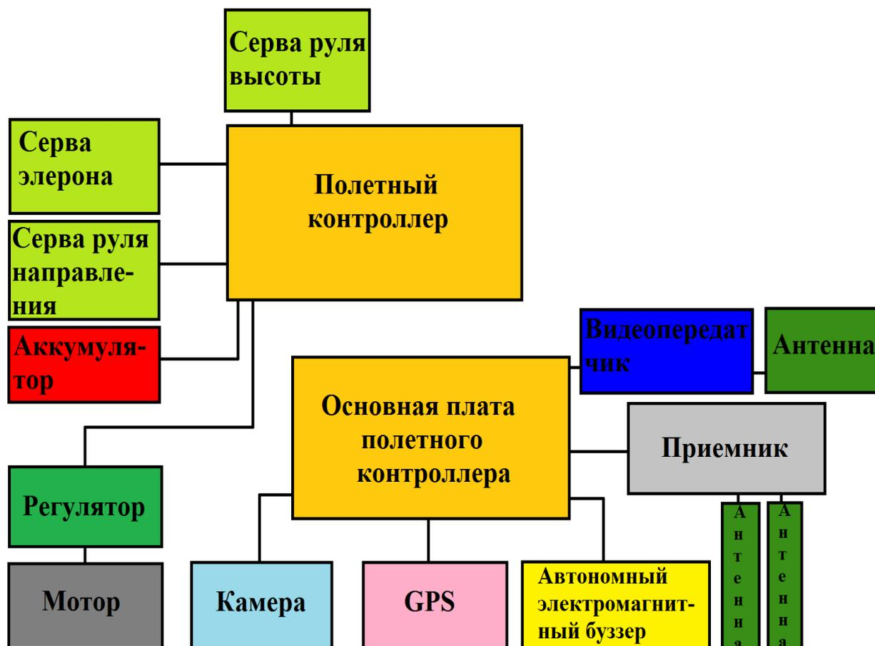
Рисунок 1 – Блок-схема сборки электродеталей авиамодели
