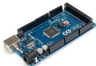
Рисунок 1 – Arduino Mega
