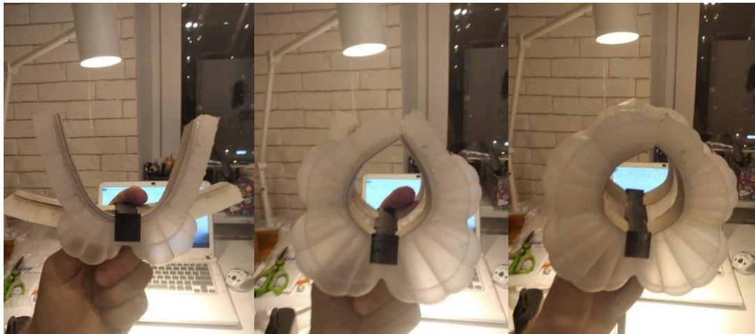
Рисунок 16 – порядок сгибания захвата последней версии
