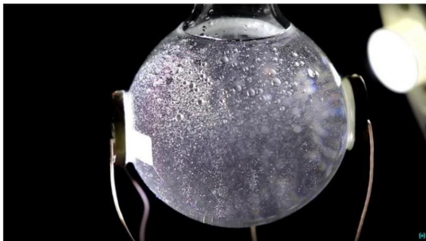
*Рис. 4 Множество пузырьков, возникших под воздействием ультразвукового излучения в проточной воде.*
