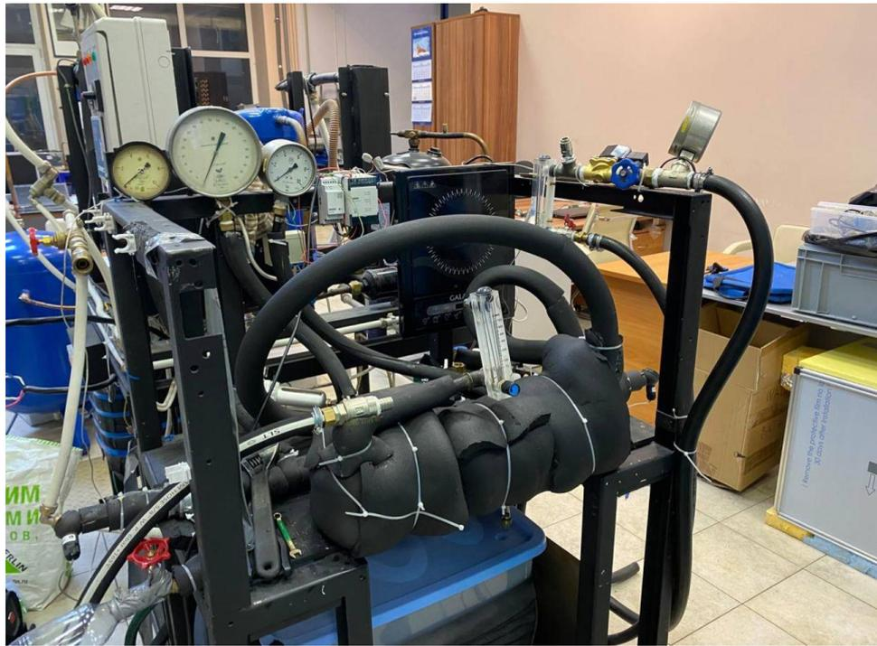
Рисунок 11 – Стенд с ТОА и теплоизоляцией
