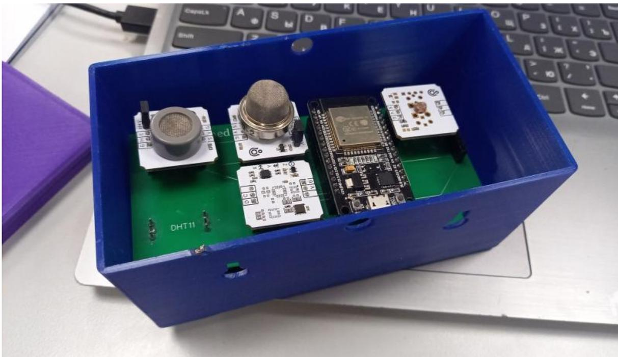
Рис. 11. Схема электронной компоновки в корпусе модуля.
