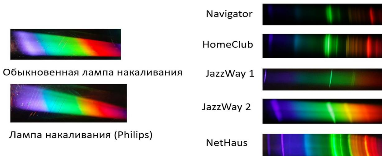
Рисунок 11 – Изображения спектров различных ламп
