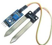
Рисунок 6 – Датчик уровня влажности почвы
