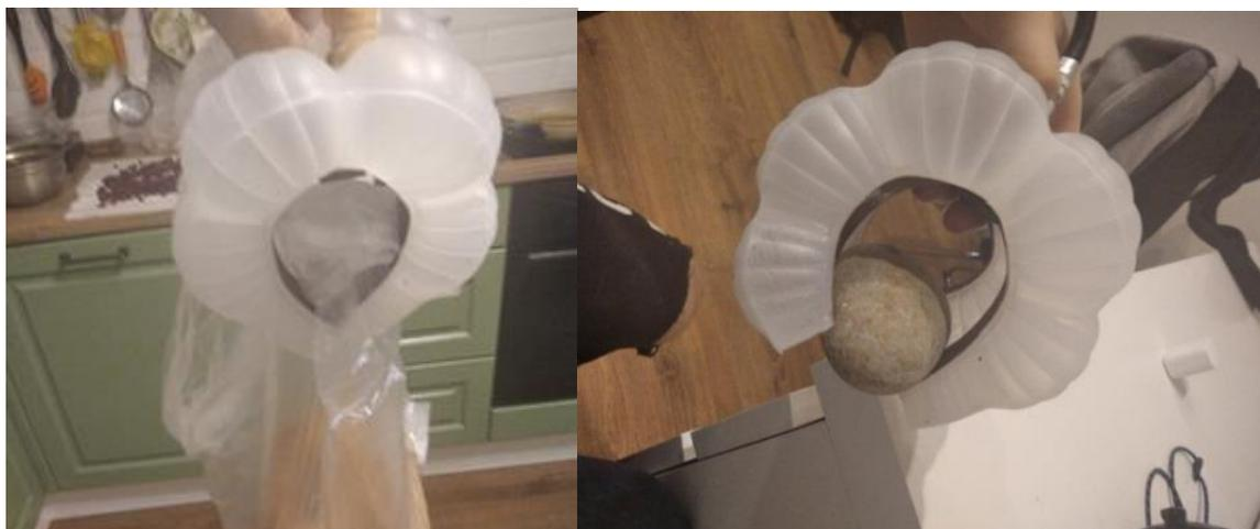
Рисунок 17 – фото удержание в захвате объектов сложной формы
