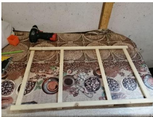
Рисунок 12 – Соединение нижней рамки
