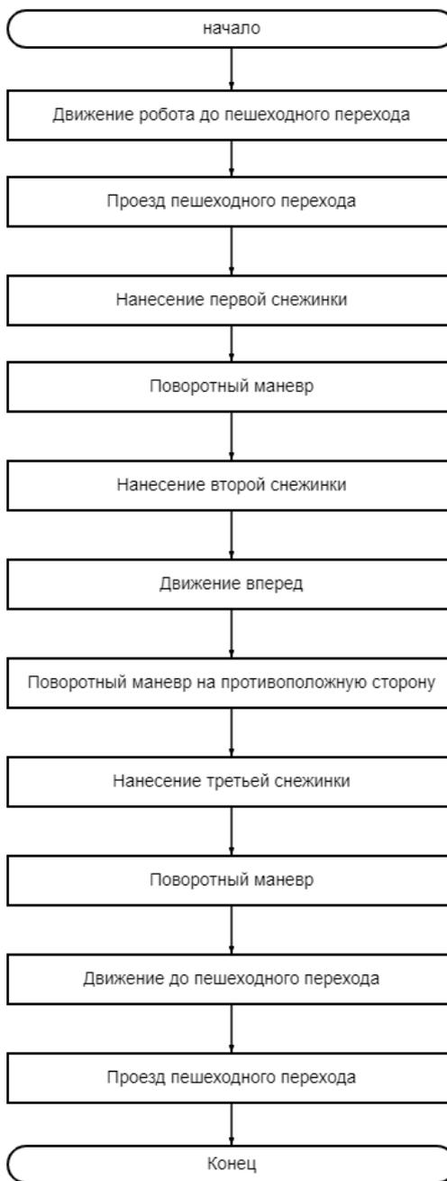
Рисунок 24 – Алгоритм движения робота
