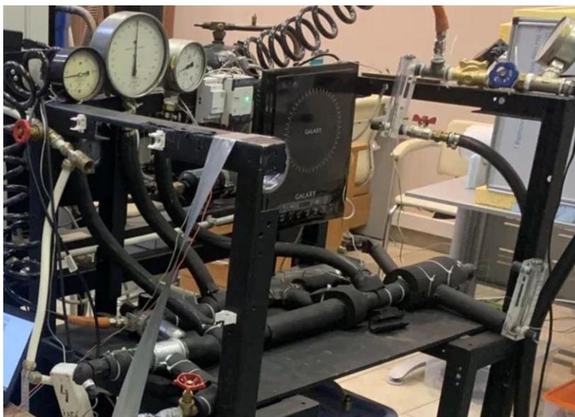
Рисунок 7 – Стенд с теплоизоляцией
