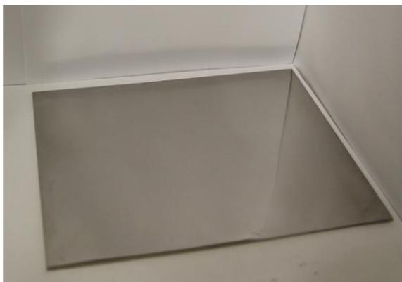
**Рис. 3.** Стальная пластина (12X18H10Т).
