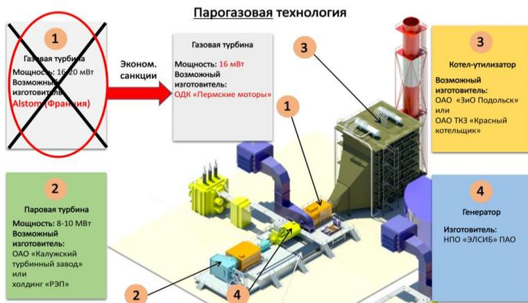
**Рис. 3.** Проект импортозамещения электроэнергетического оборудования на примере ТЭЦ «ВТИ».
