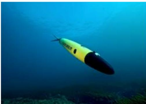
**Рис. 1.** Глайдер (Подводный планер)
