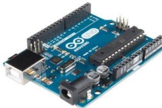
**Рис. 8.** Микроконтроллер Arduino UNO.
