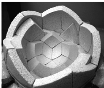
Рис. 1.3. Слоистая структура линзы Лüneберга из неоднородного диэлектрика.
