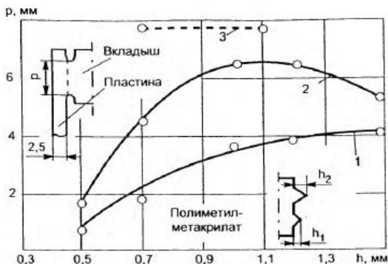
Рис.10. Зависимость ширины прозрачного участка от высоты V-образного выступа ( A = 25 \text{ мкм} , P_{\text{ст}} = 0,8 \text{ Мпа} , \phi = 90^\circ , c = 0,4 \text{ мм} ) 1 – 3 вкладыш с одним, двумя выступами одинаковой высоты и выступами разной высоты соответственно ( h_1 = 0,7 \text{ мм} , h_2 = 1,1 \text{ мм} ).
