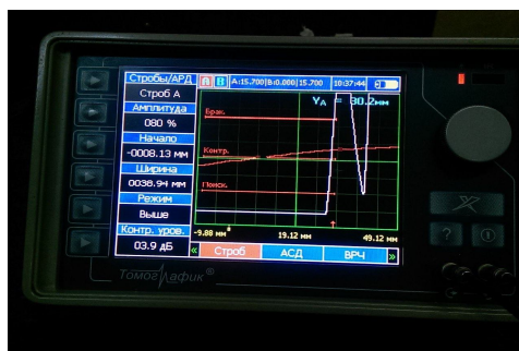
Рис. 17. Показание дефектоскопа при анализе отверстия на 30мм площадью 5\text{мм}^2
