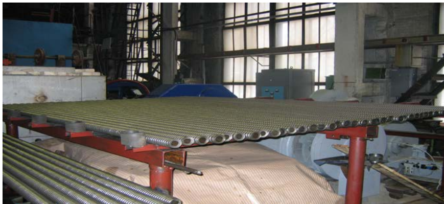
Рис. 4. Пакет труб после обработки на стане.
