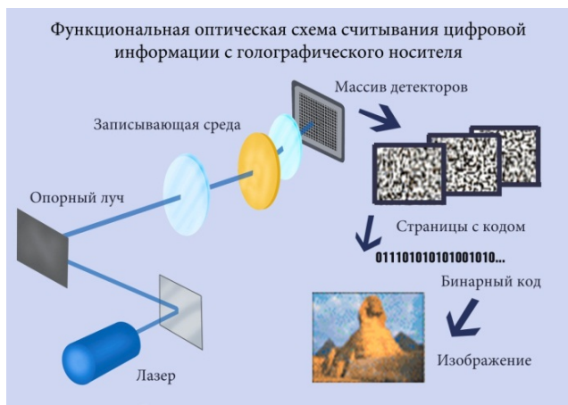
Рис. 5. Функциональная оптическая схема считывания цифровой информации на голографический диск.
