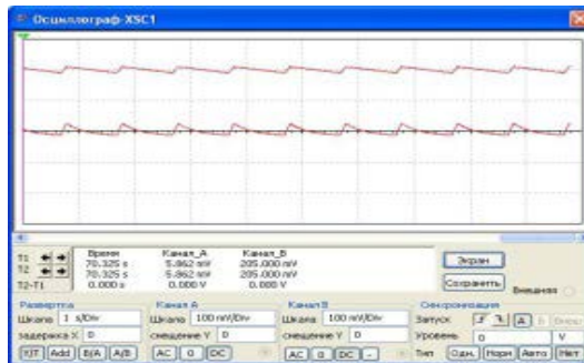
Рис. 8. Осциллограмма сигнала на входе (сверху) и на выходе (снизу) ФВЧ
