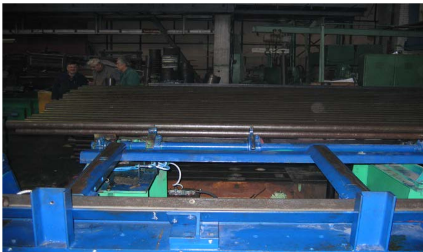
Рис. 2. Загрузка заготовок на стол стана.
