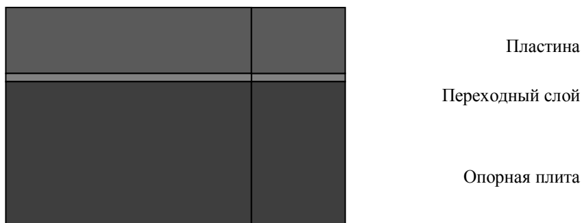
Рис. 2. Поперечное сечение геометрической модели.
