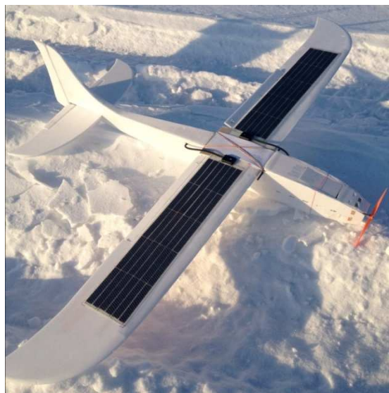
Рис.1. Планер с закрепленными фотоэлементами готов к полету
